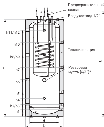
Рис. 19. Условная схема теплоаккумулятора серии Kumulo W (размеры в таб. 1)
